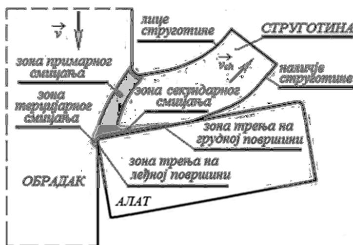
Слика 2.1. Основне зоне деформисања и трења у процесу настанка струготине [37]
