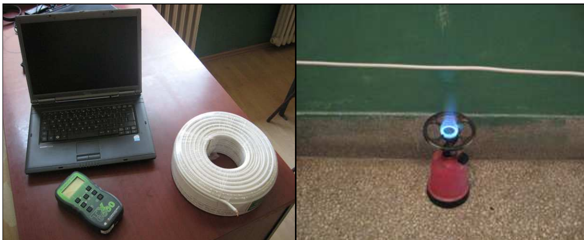
Слика 3.2.1. Главни делови мерне опреме: лаптоп Fujitsu Siemens V5333, импулсни рефлектометар TX6000, коаксијални кабл RG 6/U (лево) и гасни горионик (десно)
