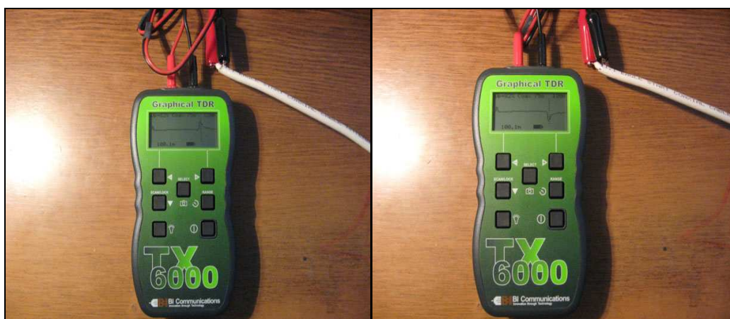
Слика 3.1.2. Провера коаксијалног кабла RG 6/U дужине 100 m за отворен крај кабла (лево) и за кратко спојен крај кабла (десно) импулсним рефлектометром TX 6000
