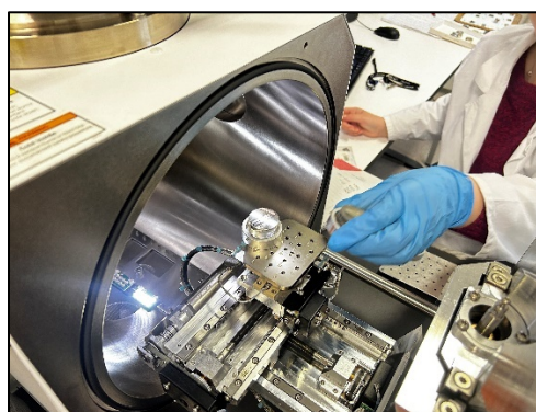
Slika 3.36 Priprema i izgled uzorka za analizu poprečnog preseka zalepljenih spojeva
