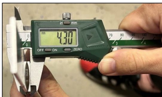
Slika 3.23 Prikaz provere debljine sloja lepka zalepljenog spoja
