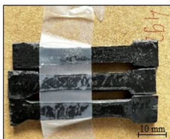
Slika 3.6 Deo izrađenih epruveta od lepka SikaPower®-492 G prema standardu SRPS ISO 527-1 [147]
