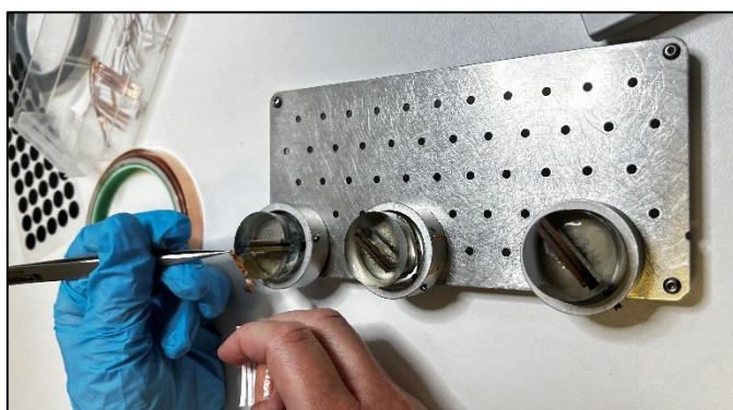
Slika 3.36 Priprema i izgled uzorka za analizu poprečnog preseka zalepljenih spojeva
