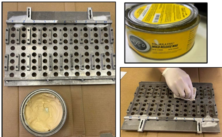
Slika 3.10 Priprema kalupa pre lepljenja: premazivanje kalupa voskom Mold Release Wax
