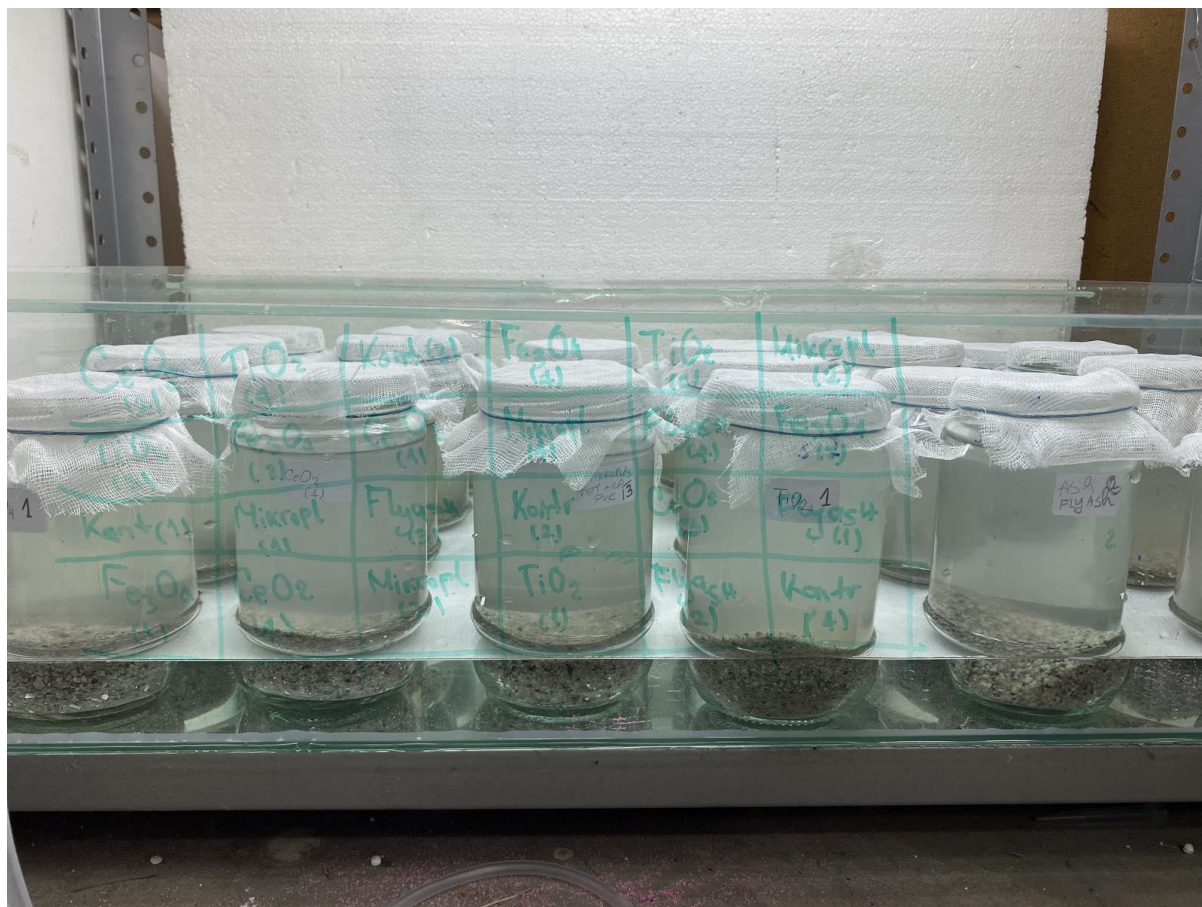
Слика 9. Изотермална комора са постављеним репликама за хронични екотоксиколошки тест (аутор: Јелена Стојановић)
