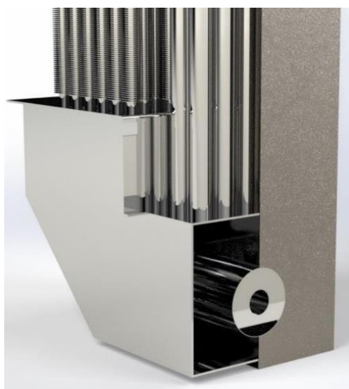
Слика 4.6. 3D приказ дела са гориоником за сагоревање пелета
