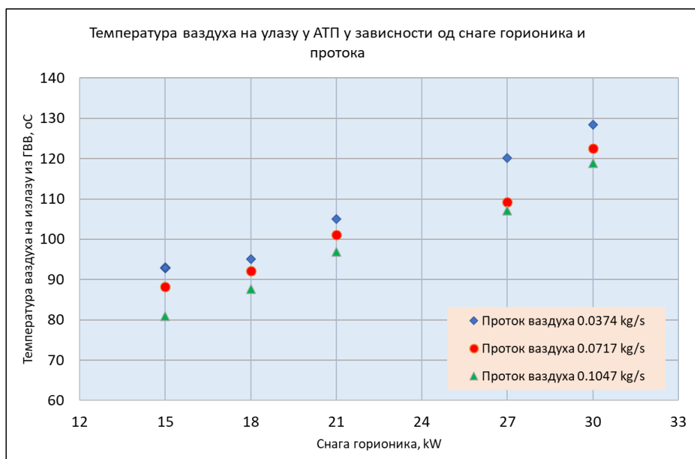
Слика 5.2. Резултати мерења температуре ваздуха на излазу из ГВВ у зависности од снаге горионика и масеног протока ваздуха у зимском режиму
