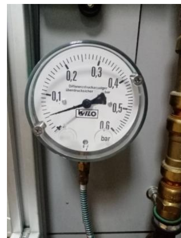
Слика 3.50. Диференцијални манометар WILO у позицији која мери \Delta p на вентилу од 4.3 \text{ kPa} при максималној отворености вентила
