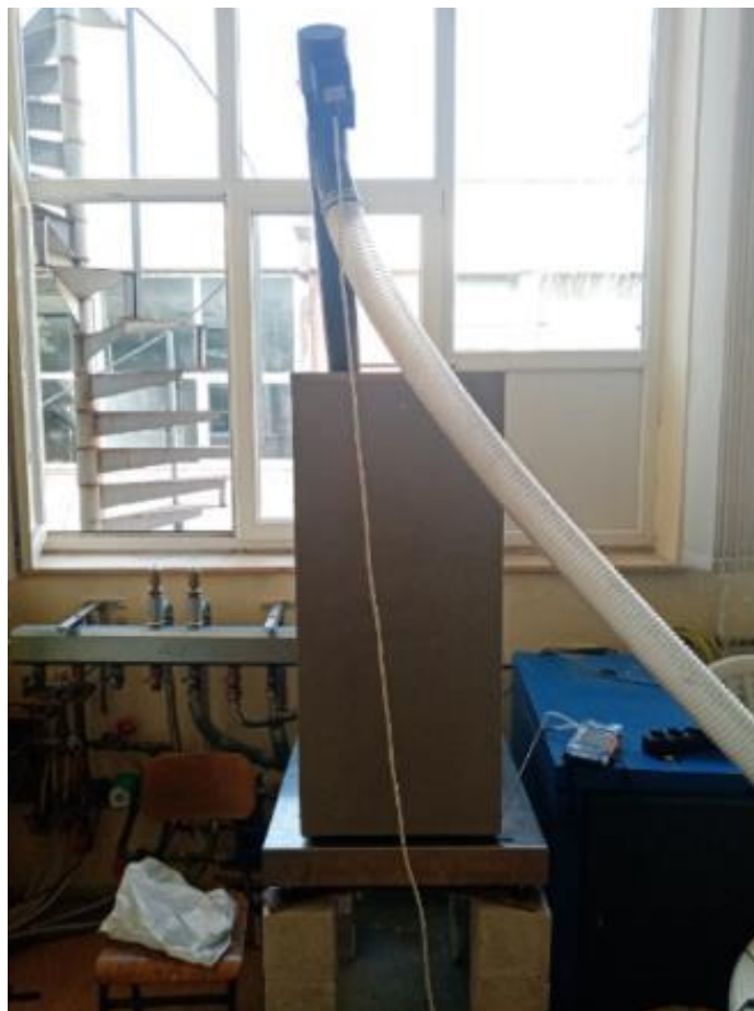
Слика 3.10. Силос пелета са постољем ваге Kern & Sohn KMB – TM и дистрибутивним цревом за пелет
