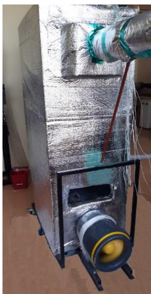
Слика 3.32. Вентилатор – Руск са супротне стране од горионика на генератору врелог ваздуха
