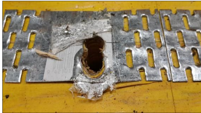
Слика 1-16. Лом назубљене плоче услед притиска по омотачу рупе (Hassanieh, Valipour, & Bradford, 2016)
