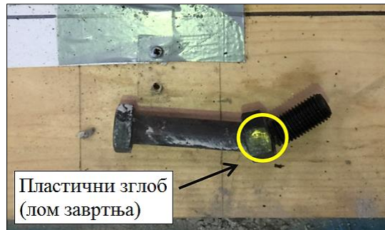
Слика 1-25. Лом завртња услед смицања кроз навој (Hassanieh, Valipour, & Bradford, 2017)
