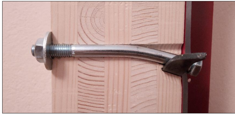
Слика 4-22. Отказ узорка серије S2 – пластични зглоб у завртњу и гњечење дрвета (пресек)
