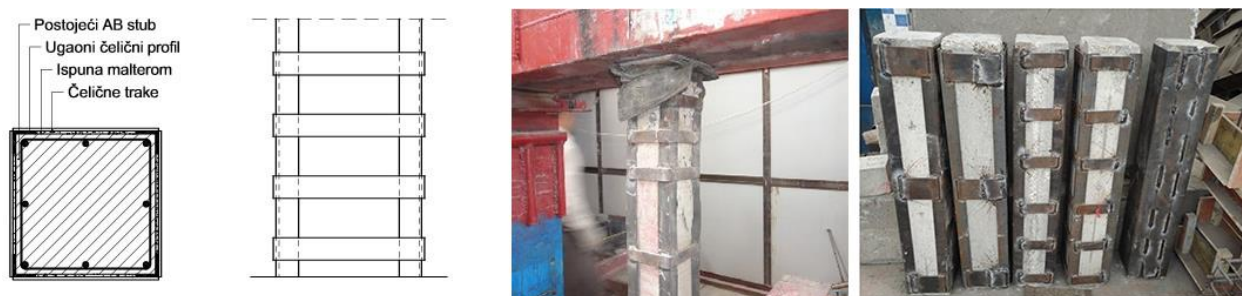
Slika 5.34. Ojačanje stubova čeličnim elementima (Belal et al., 2015; Makki & Nimmim, 2015; Najdanović, n.d.)
