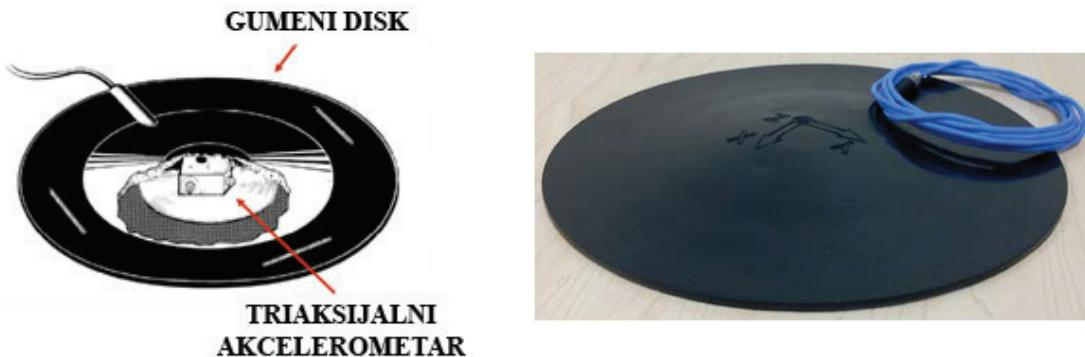
Slika 4.10. Triaksijalni akcelometar u gumenoj podlošci
