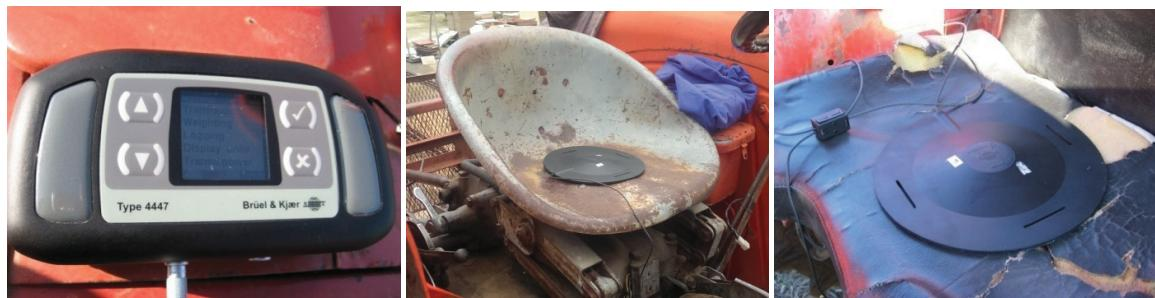
Slika 7.8. Analizator vibracija Brüel & Kjær 4447
