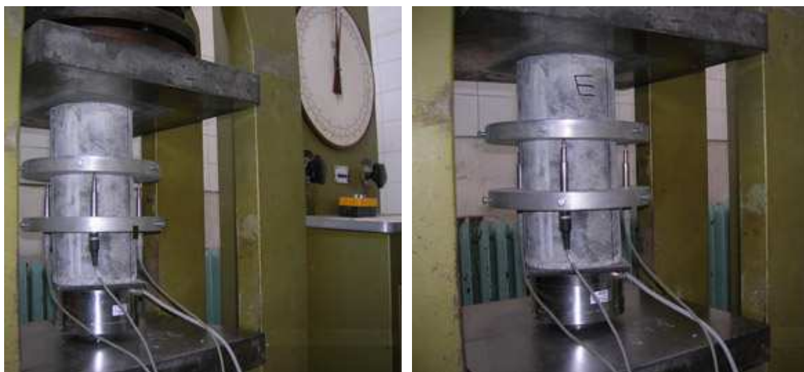
Slika 5.27. Dispozicija epruvete za ispitivanje \sigma - \varepsilon dijagrama
