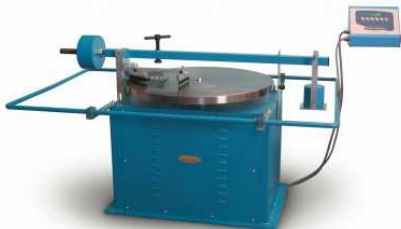
Slika 5.32. Böhme mašina za ispitivanje otpornosti prema habanju brušenjem
