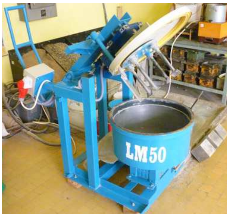
Slika 5.7. Laboratorijska protivstrujna mešalica „Metalika“ Sopot
