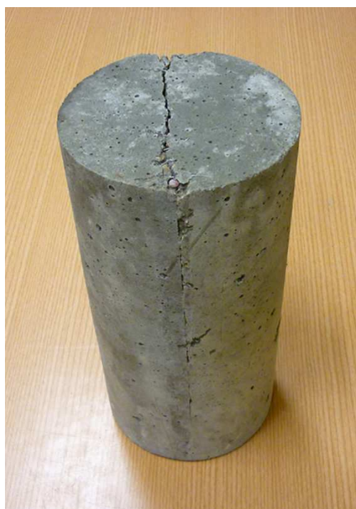
Slika 5.20. Uzorak mikroarmiranog betona nakon ispitivanja čvrstoće pri zatezanju cepanjem
