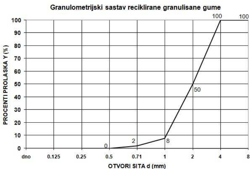
Slika 5.3. Granulometrijska kriva upotrebljene reciklirane granulirane gume
