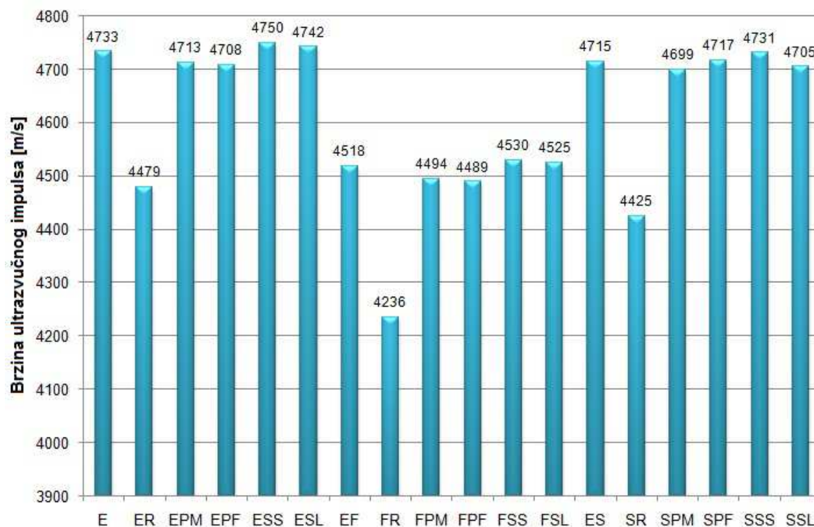
Slika 5.24. Prikaz rezultata ispitivanja brzina prolaska ultrazvučnog impulsa kroz beton
