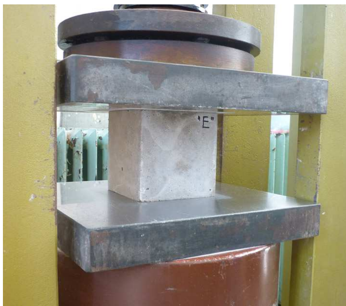
Slika 5.13. Određivanje čvrstoće pri pritisku očvrstlog betona
