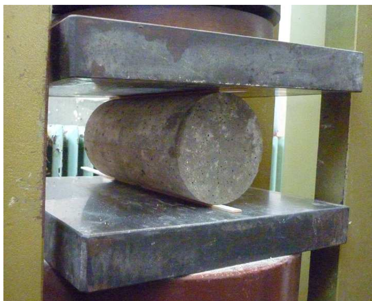
Slika 5.18. Dispozicija ispitivanja čvrstoće pri zatezanju cepanjem
