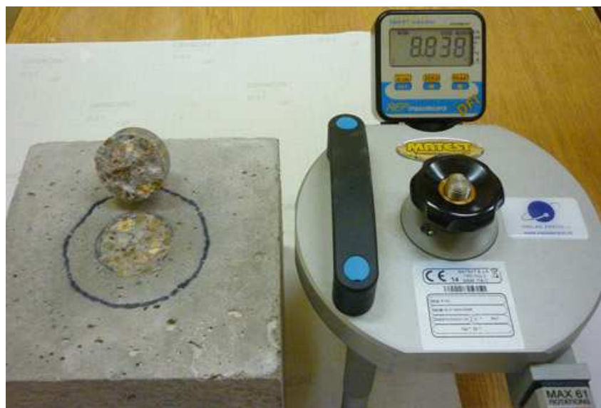
Slika 5.21. „Pull-off“ aparatura i uzorak betona nakon ispitivanja
