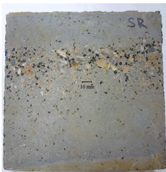
Slika 5.38. Izgled površine uzorka betona serije SR nakon ispitivanja hidro-abrazivne otpornosti
