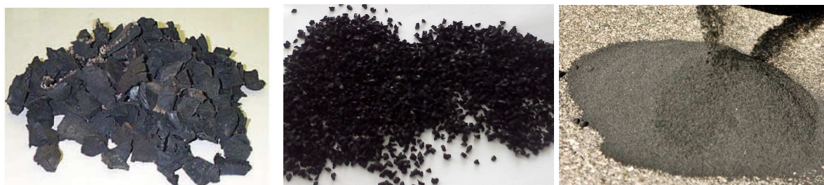
Slika 3.13. Oblici reciklirane gume koji se koriste u tehnologiji proizvodnje betona: seckana guma (levo), drobljena guma (u sredini) i zemljana guma (desno)
