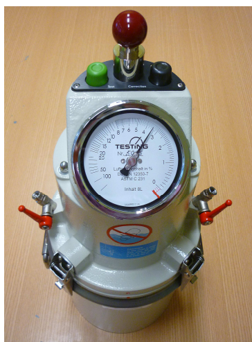
Slika 5.12. Ispitivanje sadržaja vazduha u svežem betonu
