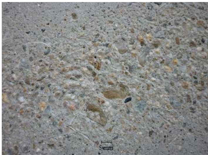
Slika 5.42. Površina uzorka betona mikroarmiranog polipropilenskim vlaknima
