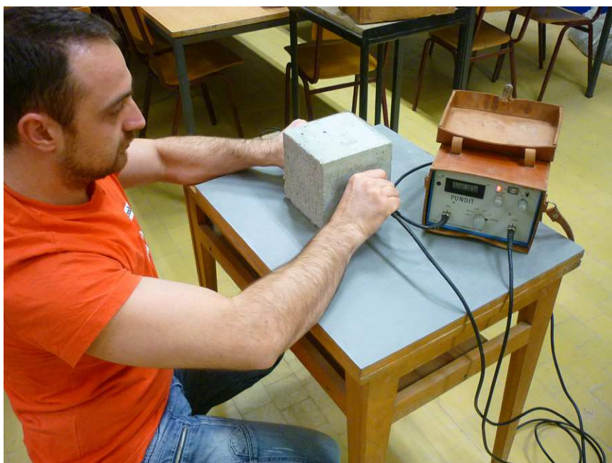
Slika 5.23. Određivanje brzine prolaska ultrazvučnog impulsa kroz beton
