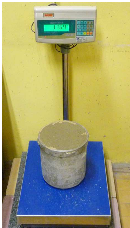
Slika 5.11. Ispitivanje zapreminske mase zbijenog svežeg betona
