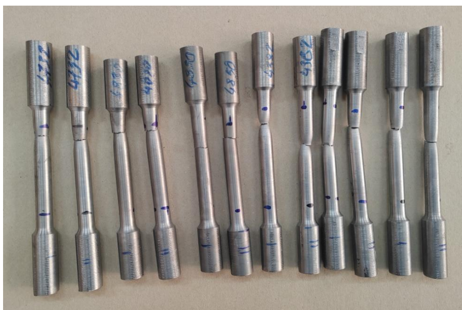
Slika 7.9 Pokidane epruvete ispitivanih čelika
