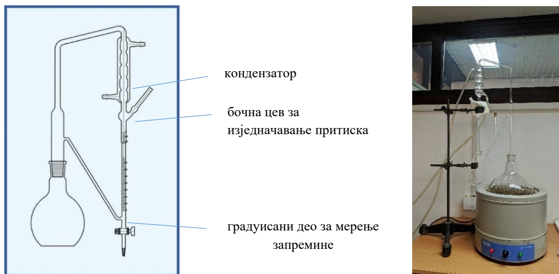
Слика 12. Приказ апаратуре по Клевенцеру коришћен за добијање етарских уља
