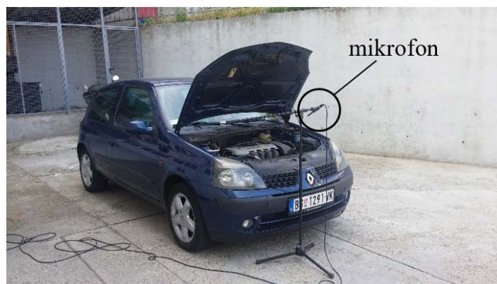
Slika 5. Pozicioniranje mikrofona u oblasti iznad motornog prostora sa otvorenim poklopcem motora
