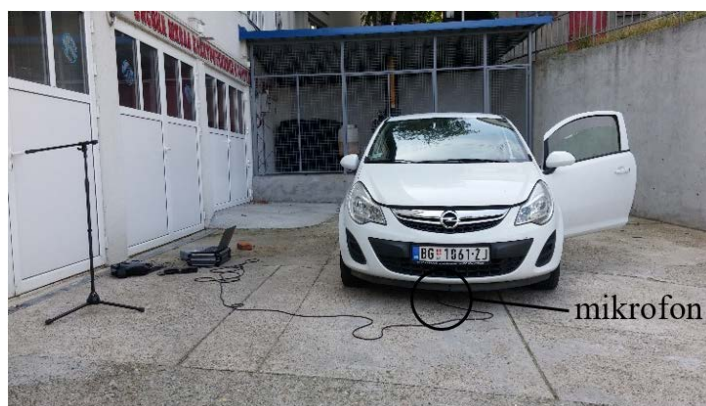
Slika 6. Pozicioniranje mikrofona u oblasti ispod motornog prostora
