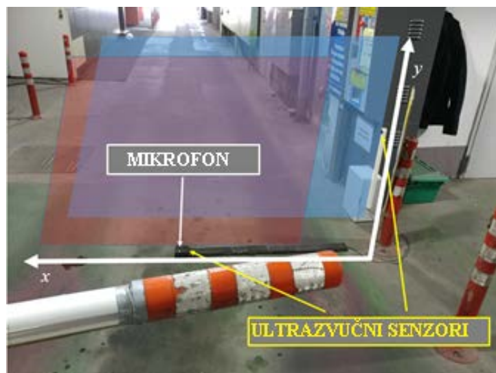
Slika 25. Prikaz ravni detekcije ultrazvučnih senzora
