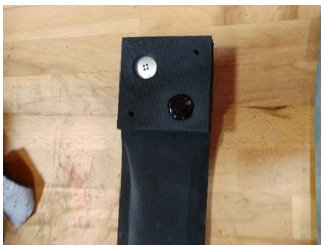
Slika 29. Zaštita mikrofona i ultrazvučnog senzora od slučajnog prelaska točkom
