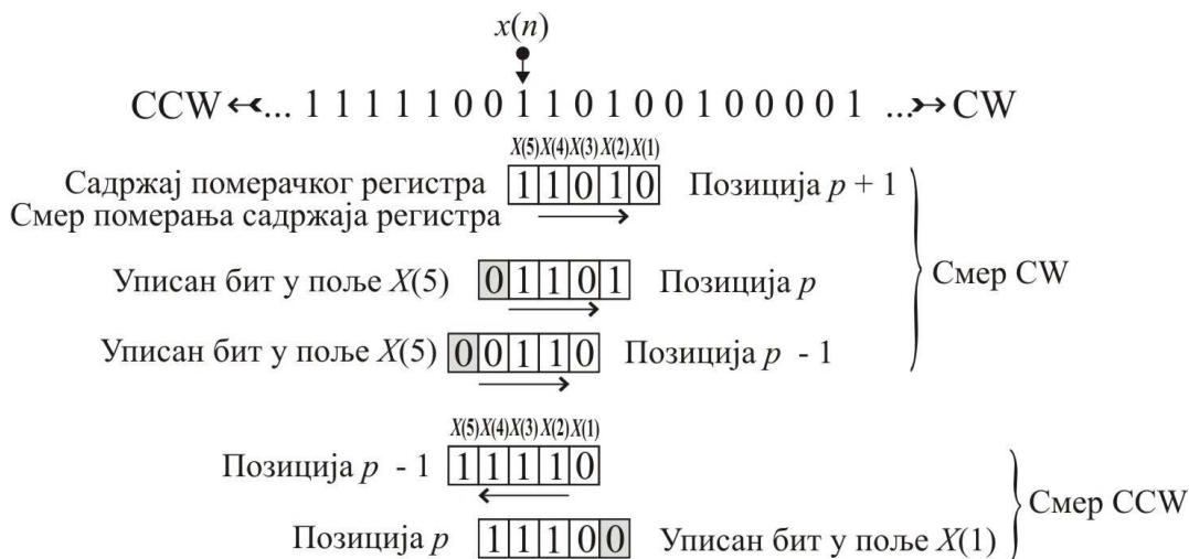
Слика 2.2. Формирање читане кодне речи у померачком регистру при окретању диска енкодера у оба смера.
