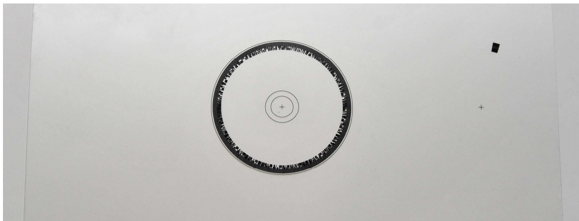
Слика 4.9. Фотографија пластичне фолије на којој је одштампан цртеж кодног диска.
