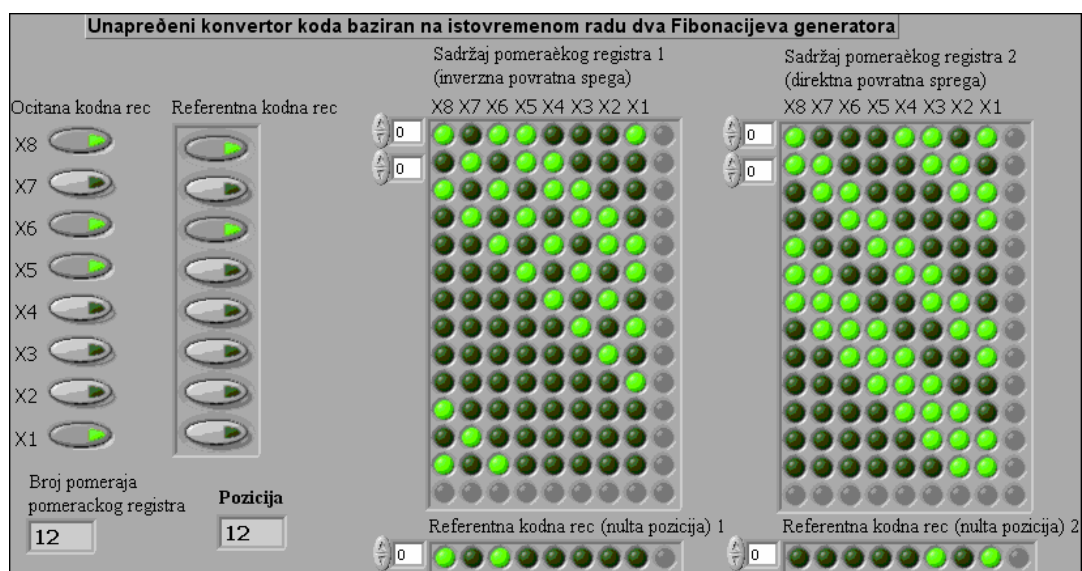
Слика 2.23. Предњи панел унапређеног серијског конвертора кода базираног на два Фибоначијева генератора.
