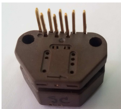
Слика 4.25. Оптички читач M832-1024-6T-U произвођача Дунараг.
