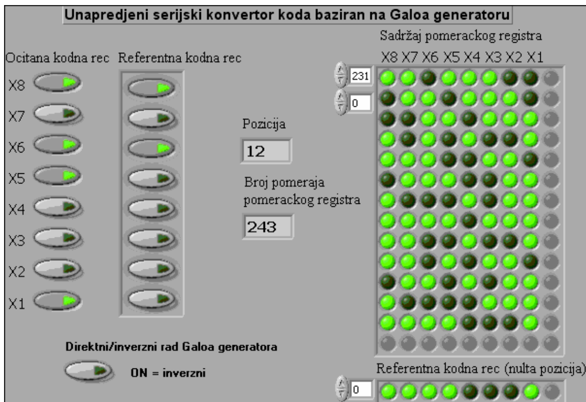
Слика 2.21 а) Предњи панел серијског конвертора кода базираног на Галоа генератору.
