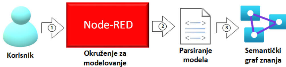
Slika 3.11 Interakcija komponenti u fazi modelovanja: 1-Korisnički unos; 2-JSON fajl; 3-Semantički tripleti.
