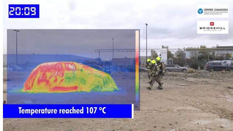
Сл. 7.26 Термовизијски снимак запаљеног електричног аутомобила Nissan Leaf испод специјалног покривача чија је температура опала на 107 °C [34]
