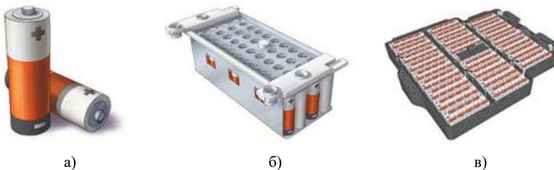
Сл. 7.5 а) Батеријска ћелија, б) батеријски модул и в) батеријски пакет
