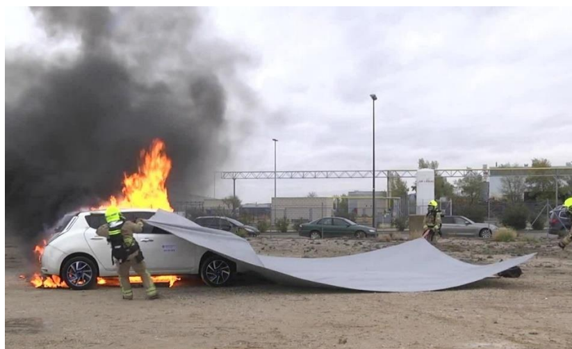
Сл. 7.25 Сузбијање пожара специјалним прекривачем [34]
