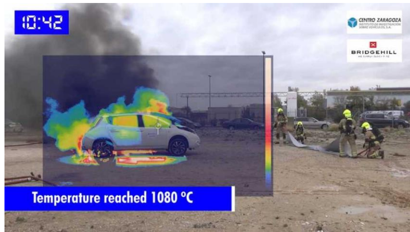
Сл. 7.24 Термовизијски снимак запаљеног електричног аутомобила Nissan Leaf чија је температура приликом пожара достигла 1080 °C [34]
