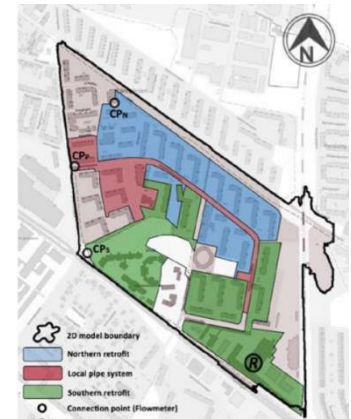
Три система за каналисање кишног отицаја:
