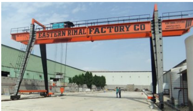
Slika 2.2. Portalni dvogredi kran (slika preuzeta sa internet adrese https://www.hsn.com.tr/urun/cift-kirisli-portal-vincler-86 dana 28.09.2023. god.)
