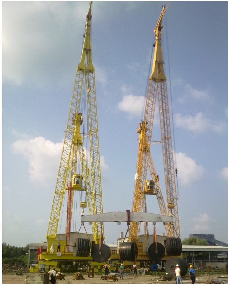
Slika 2.21. Tandemski rad Derik kranova DK003 i DK004
