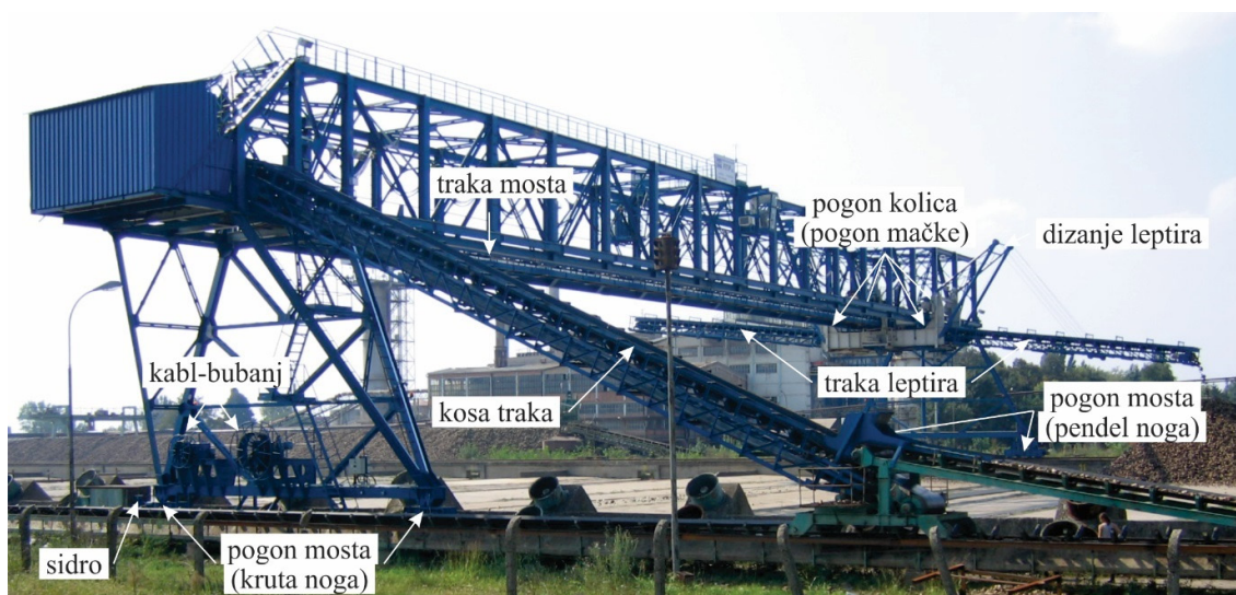
Slika 3.12. Pretovarni most na otvorenom skladištu šećerne repe u Fabrici šećera TE-TO Senta
