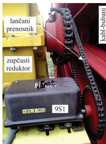
Slika 4.34. Vretenasti bregasti prekidač – detekcija broja namota kabla na granicama sektora
