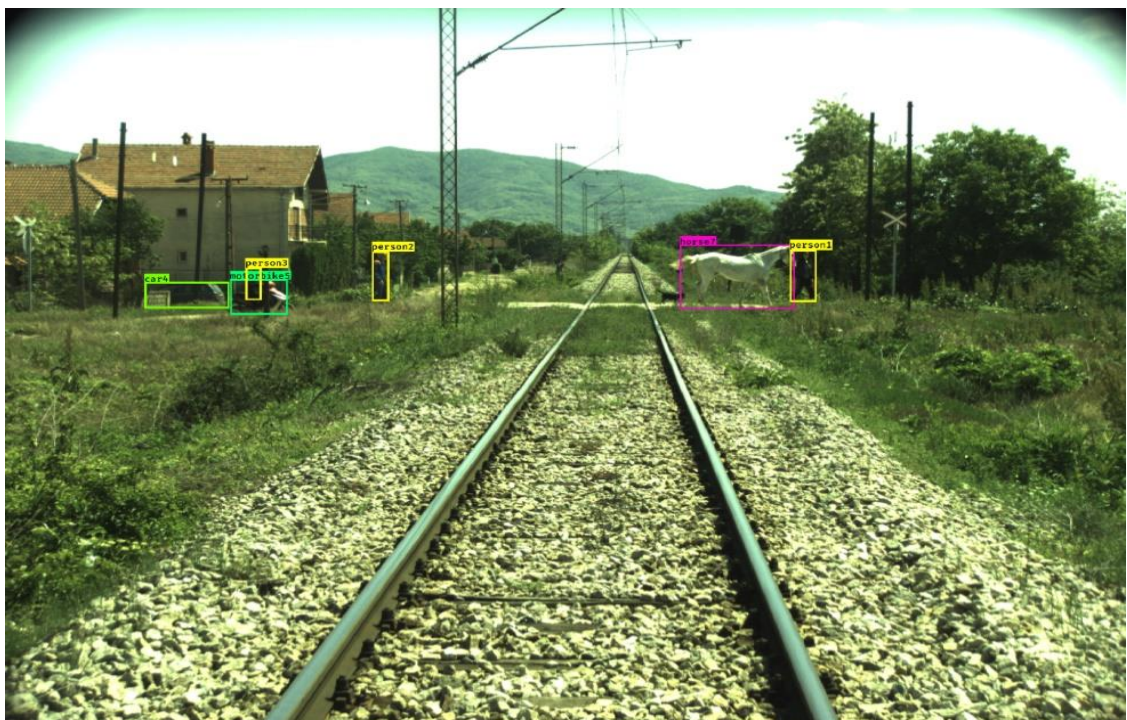
Слика 3.4. Тестирање прототипа OD система у реалном саобраћају: детектоване су особе и животиња који прелазе путни прелаз док се воз приближава, особа на мотору која чека на левој страни прелаза и аутомобил паркиран лево од колосека [43]
