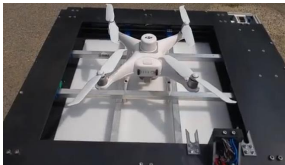
Слика 8.4 Беспилотна летелица позиционирана на станици за пуњење поред пруге [89]
