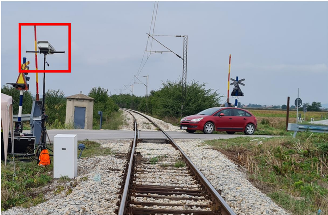
Слика 8.8 Стабилни ласерски систем за детекцију препрека на путном прелазу Печењевце [92]
