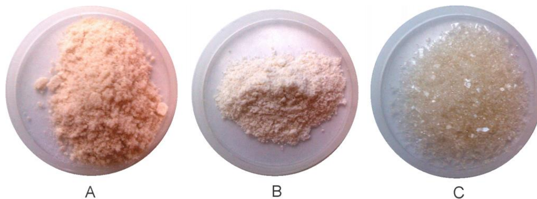
Slika 19. Izgled: (a) sintetisanog sulfanilamida, (b) inkluzionog kompleksa sulfanilamid: \beta -ciklodekstrin i (c) inkluzionog kompleksa sulfanilamid:2-hidroksipropil- \beta -ciklodekstrin
