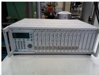
Слика 6.3 Систем за аквизицију података HBM MGCplus
