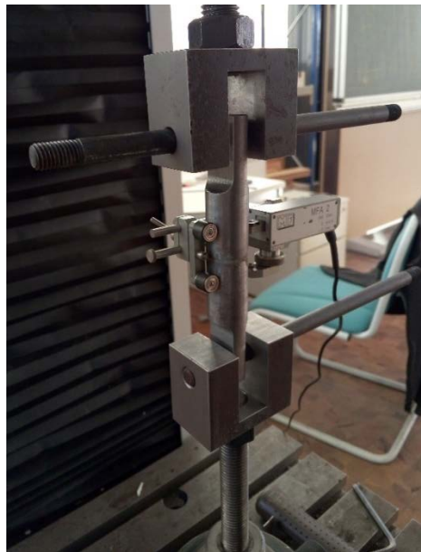
Слика 4.28 Диспозиција при испитивању узорка чеоног споја
