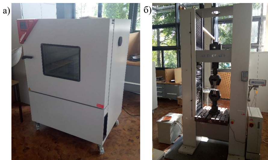
Слика 4.13 Уређаји за кондиционирање и испитивање затезањем:
