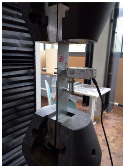
Слика 4.24 Диспозиција при испитивању двоструког преклопног споја под дејством статичког оптерећења
