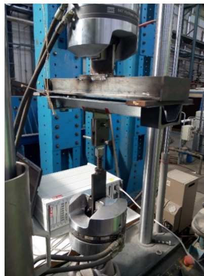
Слика 6.2 Диспозиција при испитивању фасадног споја под дејством цикличног оптерећења
