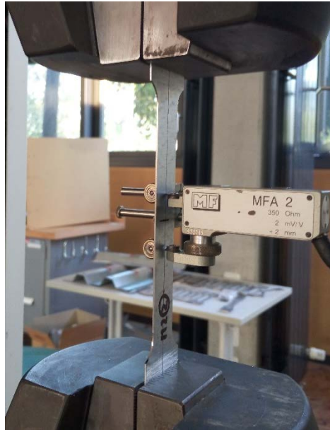
Слика 4.31 Диспозиција при испитивању епрувете поцинкованог лима
