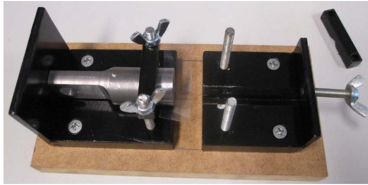
Слика 4.27 Уређај за монтирање адхезионих чеоних спојева
