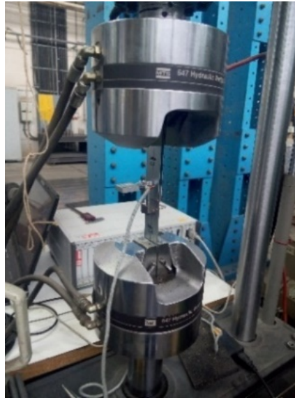
Слика 6.19 Диспозиција при испитивању двоструког преклопног споја под дејством цикличног оптерећења
