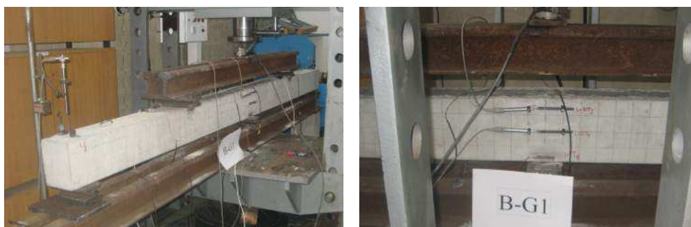
Слика 6-12: Положај угибомера U_1 (LVDT) и дилатомера ( D_1 и D_2 )
