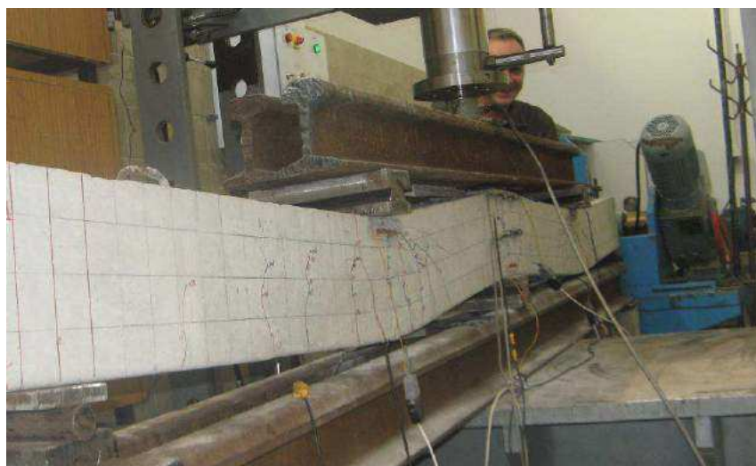
Слика 6-68: Деформација контролне греде под оптерећењем
