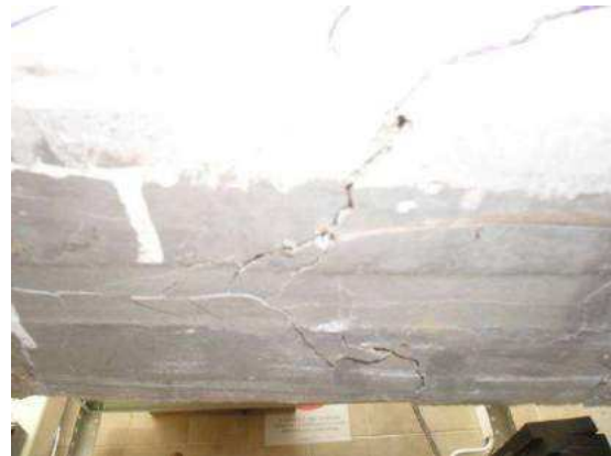
Слика 6-82: Карактеристичне попречне прлине у бетону које пресецају прорез са епоксидном испуном (доња страна греде)
