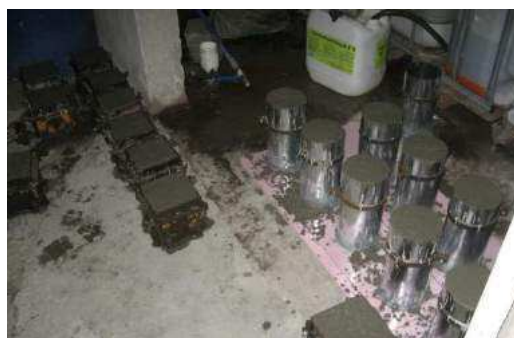
Слика 6-5: Пробне епрувете облика коцке и цилиндра узете при бетонирању гредних носача
