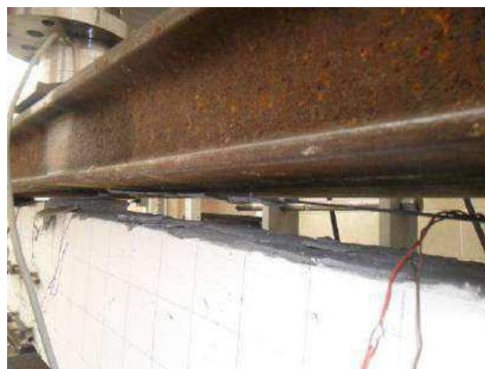
Слика 6-97: Губитак везе на споју бетона и епоксидног лепка на горњој страни носача
