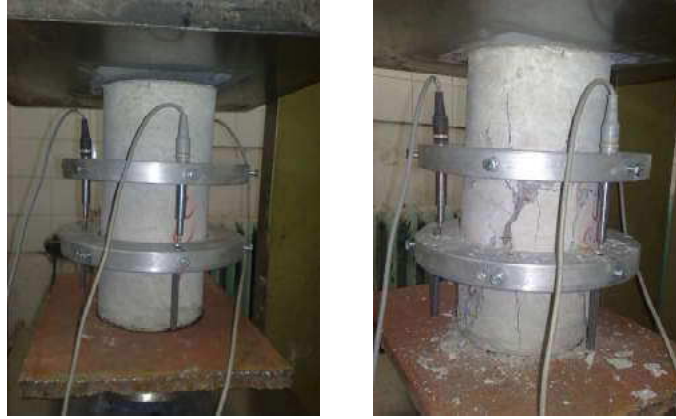
Слика 6-18: Диспозиција епрувета за испитивање дијаграма зависности између напона и дилатације и одређивање статичког модула еластичности
