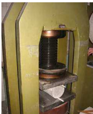
Слика 6-20: Диспозиција епрувета за испитивање чврстоће при затезању цепањем (пре и после оптерећења)
