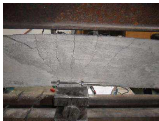
Слика 6-75: Распоред прлина над ослоњцем (задња страна носача)
