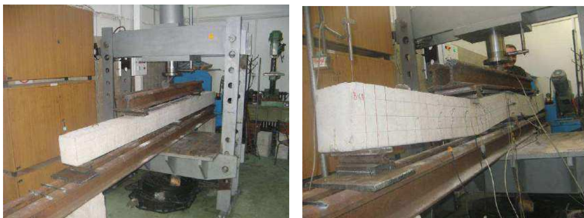
Слика 6-22: Диспозиција контролног гредног носача пре оптерећења и под оптерећењем
