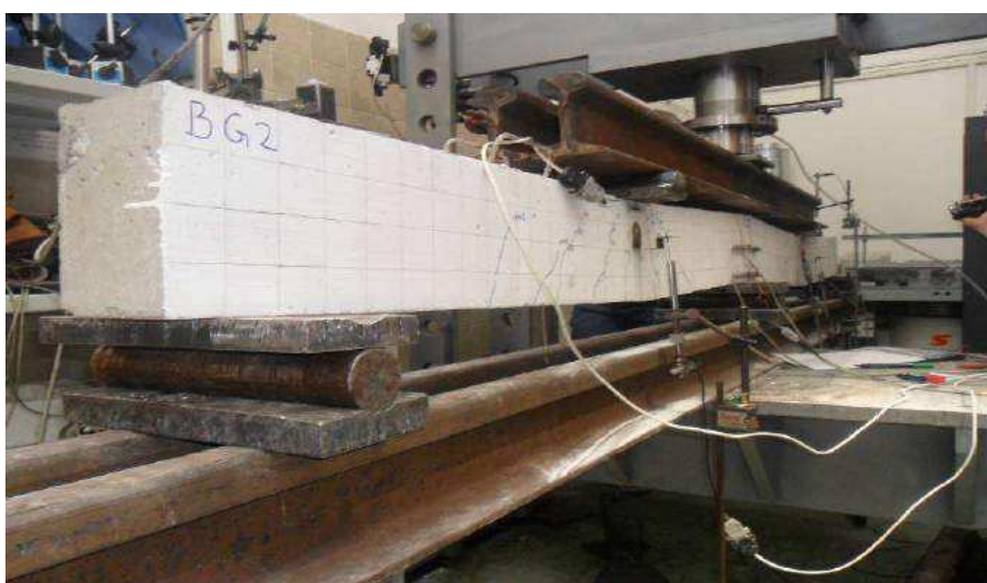
Слика 6-76: Деформација греде Б-Г2 под оптерећењем
