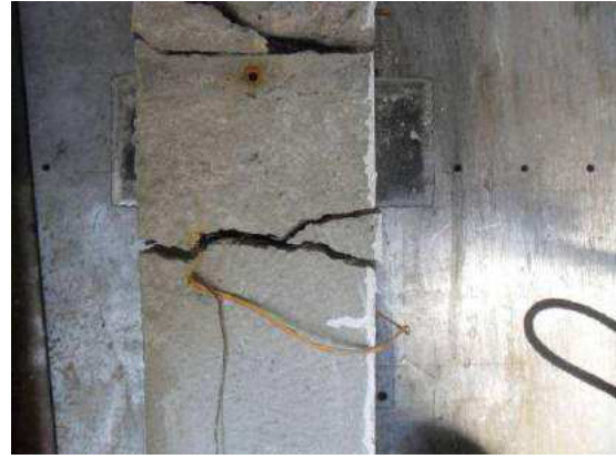
Слика 6-80: Распоред прлина и лом пресека у пресеку над ослонцем (горња страна носача)
