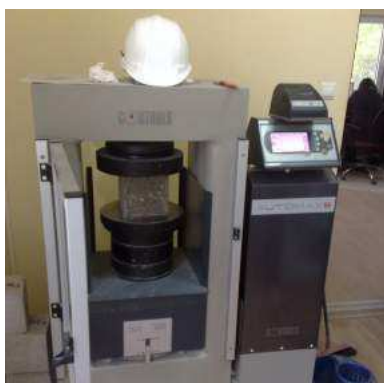
Слика 6-15: Преса Controls - Automax 5 и читавање добијених вредности
