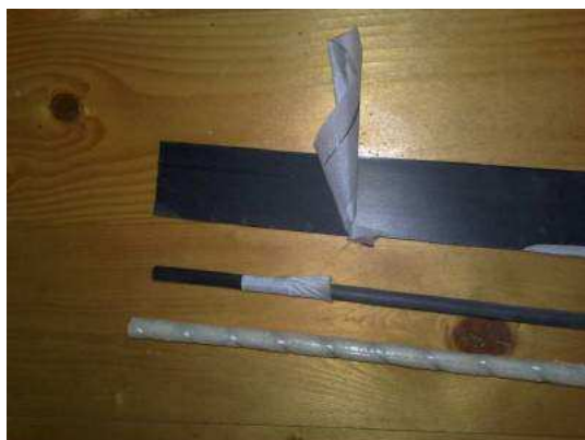
Слика 6-6: Изглед ГФРП арматуре (G-rod) и ЦФРП арматуре (C-rod и Carboplate E) са заштитном фолијом
