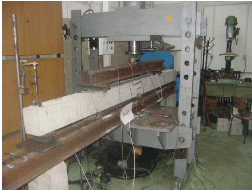
Слика 6-11: Диспозиција испитиваних гредних АБ носача ( experimental setup )
