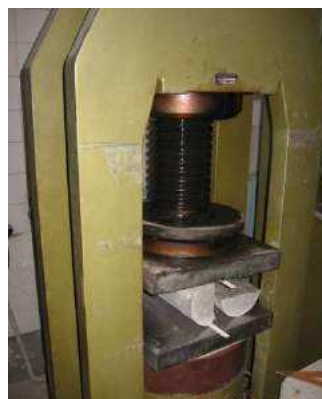
Слика 6-20: Диспозиција епрувета за испитивање чврстоће при затезању цепањем (пре и после оптерећења)
