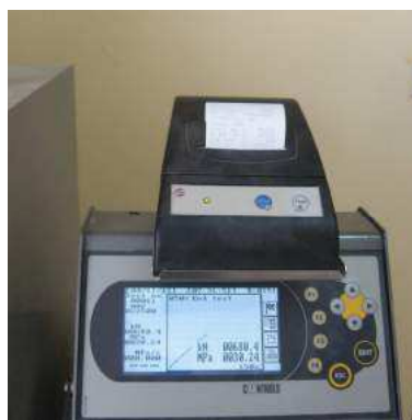
Слика 6-15: Преса Controls - Automax 5 и читавање добијених вредности
