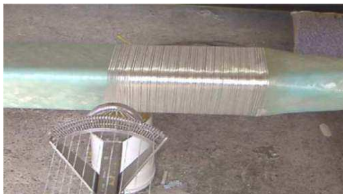
Слика 3-12: Стаклена влакна која се намотавају на троугаоуни калуп у току производње троуганих стаклених ФРП цеви намотавањем влакана (ISIS Educational module 2, 2006)
