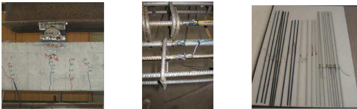
Слика 6-13: Мерне траке на бетону, челичној и ФРП арматури
