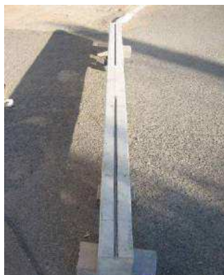
Слика 6-8: Исечени прорези код АБ греде ојачане НСМ методом
