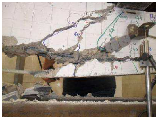
Слика 6-83: Одвајање бетона у висини заштитног слоја бетона (предња страна носача)
