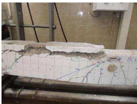
Слика 6-92: Одвајање бетона у висини заштитног слоја бетона и распоред прлина
