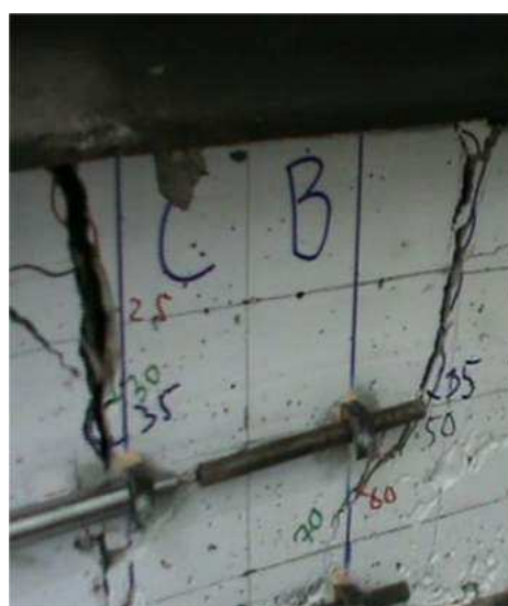
Слика 6-70: Лом пресека над ослоном контролне греде
