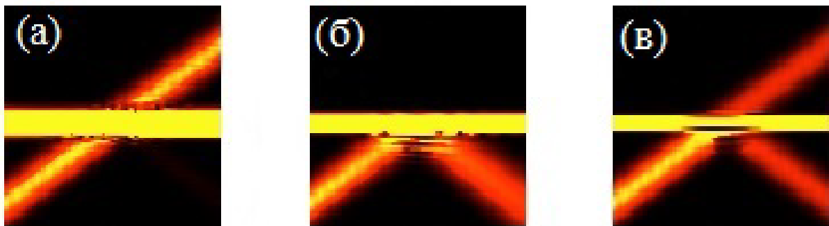
Слика 3.9 Приказ ефеката у решетки: (а) трансмисија, (б) рефлексија и (в) трансмисија и рефлексија. Жута линија представља положај дефекта у решетки.
