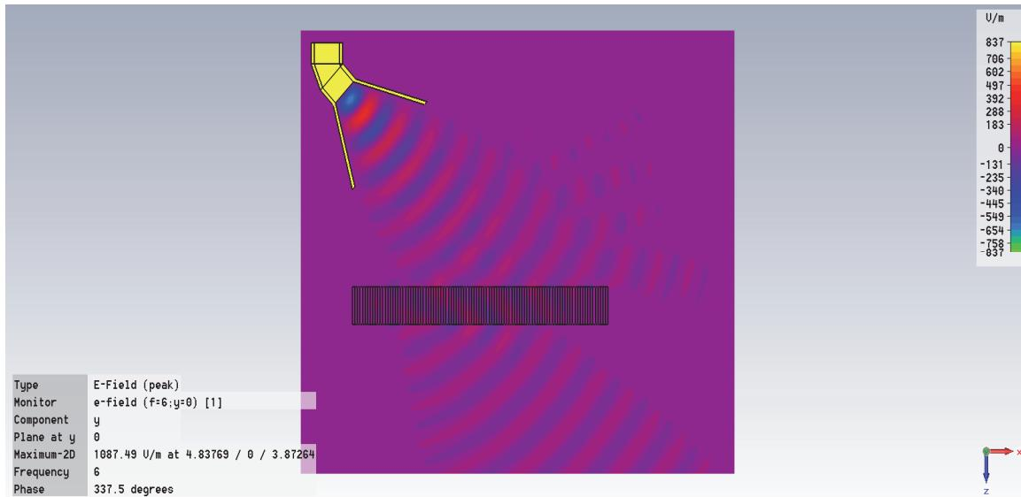
Slika 2.14 Raspodela  $E_y$  polja duž x kod GRIN metamaterijal sočivo antene ( $\theta=-45^\circ$ )
