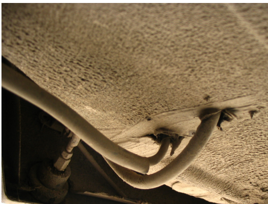
Слика 6.6: Нема вентилације мултивентила
