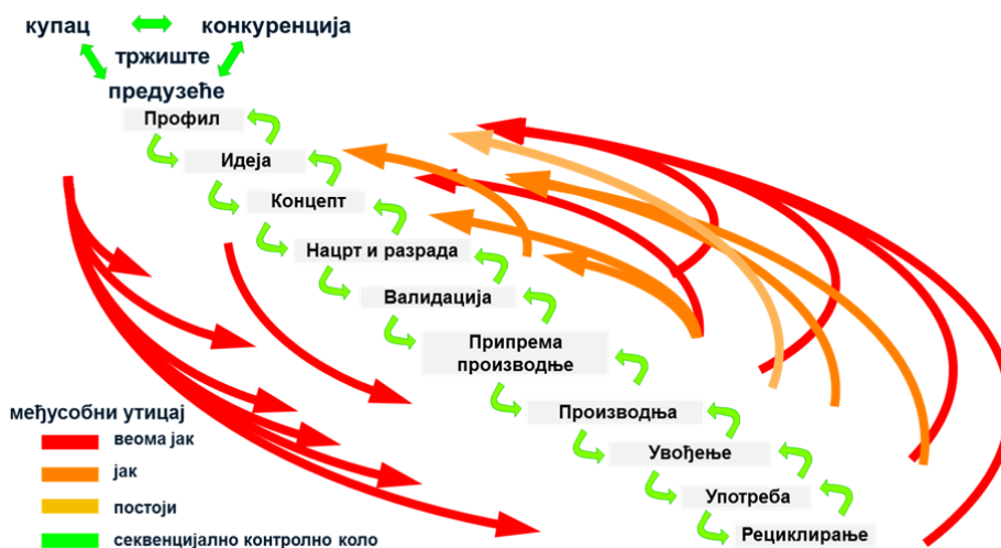
Слика 2.1. Развој производа у оквиру његовог животног циклуса [3]
