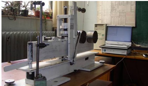
Слика 3.18. Јерзлијев механички осцилограф за испитивање динамичких карактеристика еластомера по ASTM D 945-92
